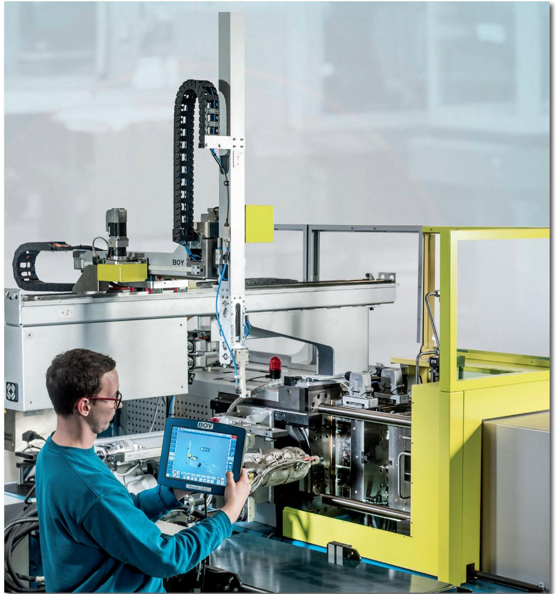
Das mobile Handbediengerät verfügt zudem über einen Not-Halt-Schalter sowie Schlüsselschalter und einen dreistufigen Zustimmungstaster, welche über eine separate Sicherheitssteuerung ausgewertet werden. Zusätzlich wird der Sicherheitskreis sowie Not-Halt-Kreis des Spritzgießautomaten überwacht, sodass
