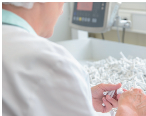
Fertigung von medizinischen Einmalartikeln unter Reinraumbedingungen (Bildquelle: Greive)
