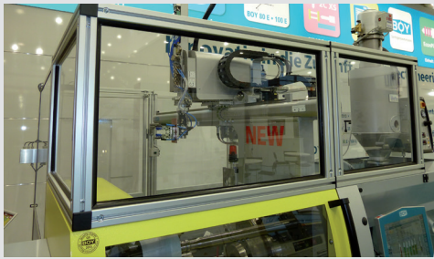
Auf der Schließeinheit positionierter Industrieroboter mit Schutzumhausung
